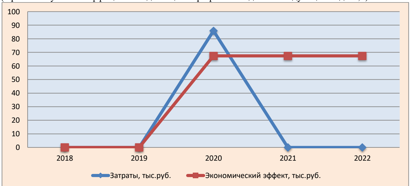
Диаграмма 3. Экономический эффект при переходе от светильников с лампами накаливания к светильникам с лампами ДНАТ.
